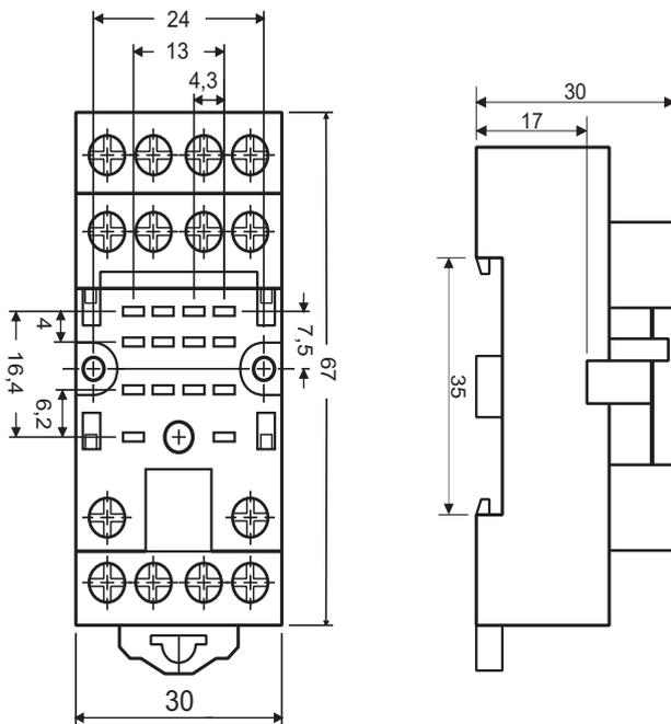
Tolerância / Tolerance:  $\pm 0,20$  mm
